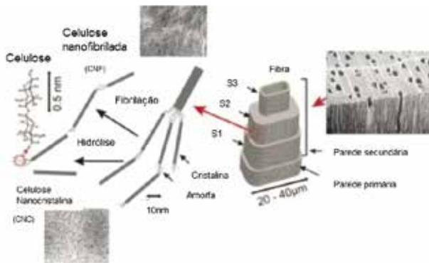
Figura 3. Estrutura da parede celular e representação da CNF e CNC.
